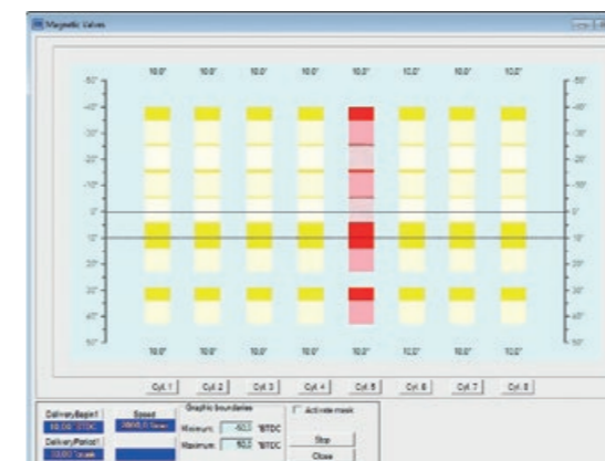
Visualisierung von Einspritzzeitpunkt und Einspritzdauer für Magnetventiltechnik
