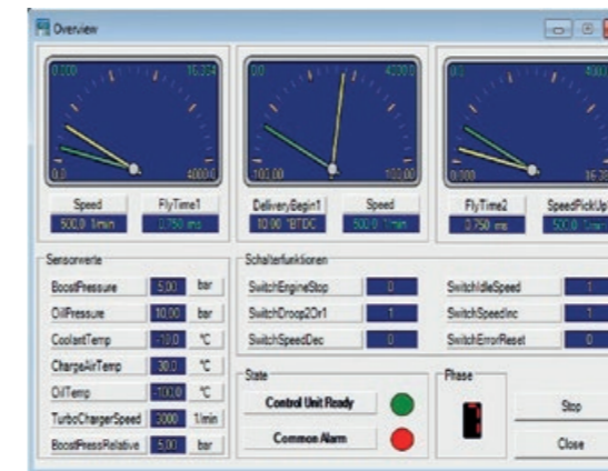
Übersicht über die wichtigsten Messwerte und Schalterstellungen
