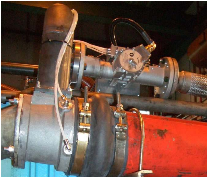
Abbildung 3: Komplette Gemischregeleinheit im Test beim Kunden
