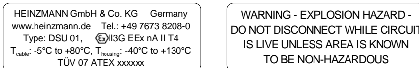
Abbildung 10: Hinweisschild am Drucksensorkabel, Vorderseite und Rückseite
